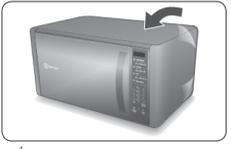
6. É obrigatória a retirada da película plástica protetora na parte externa do gabinete (quando houver). Caso você não retire a película e coloque o forno em uso, com o tempo a mesma irá aderir cada vez mais, dificultando e até tornando impossível a sua remoção sem danificar a pintura.
