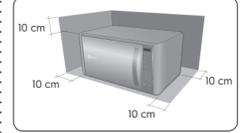
Deve-se deixar um espaço livre acima da superfície do topo do forno de, no mínimo, 10 cm. Se for instalar o forno de micro-ondas em um armário, somente opere-o com a porta do armário aberta.
