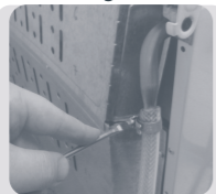
Aperte a abraçadeira com chave de fenda
