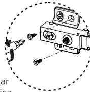
Instalar os puxadores (P1) com parafusos (P2). Fixar conforme indicado
