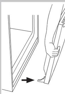
2. Destrave as duas travas da porta Forno que se encontram nas extremidades inferiores da cavidade.
