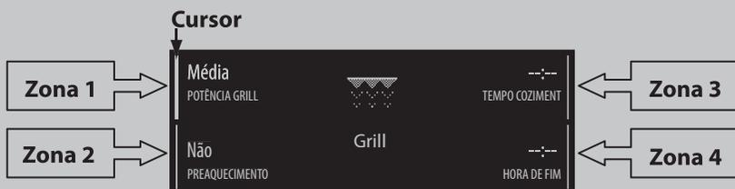
Para se movimentar nas várias zonas, use as teclas **[^]** e **[v]**; o cursor surge ao lado dos valores que podem ser modificados, seguindo a ordem acima descrita. Pressione **[OK]** para selecionar o valor, modifique-o com **[^]** **[v]** e confirme pressionando novamente a com a tecla **[OK]**.
