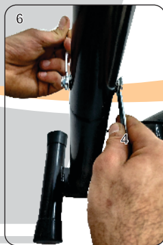
Fixe a haste do guidão da bicicleta utilizando duas chaves. Com uma delas segure o parafuso e com a outra aperte a porca até que fique totalmente firme.
