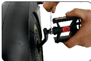
Fixe os pedais com ajuda de uma chave de boca, para montar
