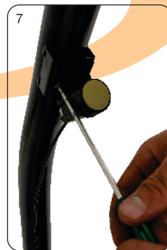
Fixe o regulador de tensão da bicicleta utilizando uma chave phillips.
