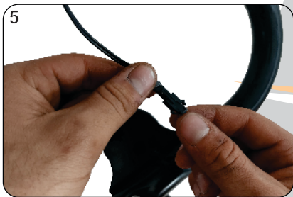
Encaixe o conector do monitor no conector do sensor, e posicione o monitor no encaixe cuidadosamente, para não danificar o cabo.
