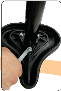
Fixe a haste do selim utilizando a chave
