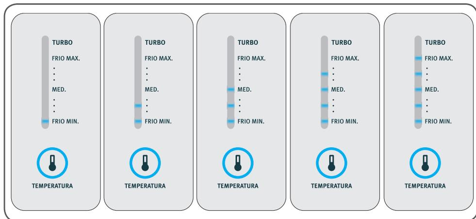
Obs.: Quando o refrigerador for energizado, o controle sempre indicará a posição MÉDIA (ajuste de fábrica).
