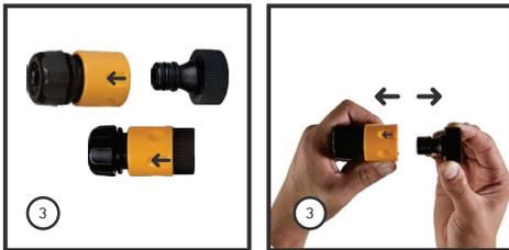
3. Destrave o espigão do engate rápido, pressionando a parte móvel no sentido da seta existente no mesmo e retire o espigão do engate rápido, separando as duas peças.
