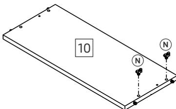
Montar a gaveta conforme a ilustração abaixo, unir as peças (10) na peça (07), utilizando a ferragem (J). Em seguida montar a peça (02) na gaveta, aplicando cola nas cavilhas. Efetuar esses procedimentos nas duas gavetas.
