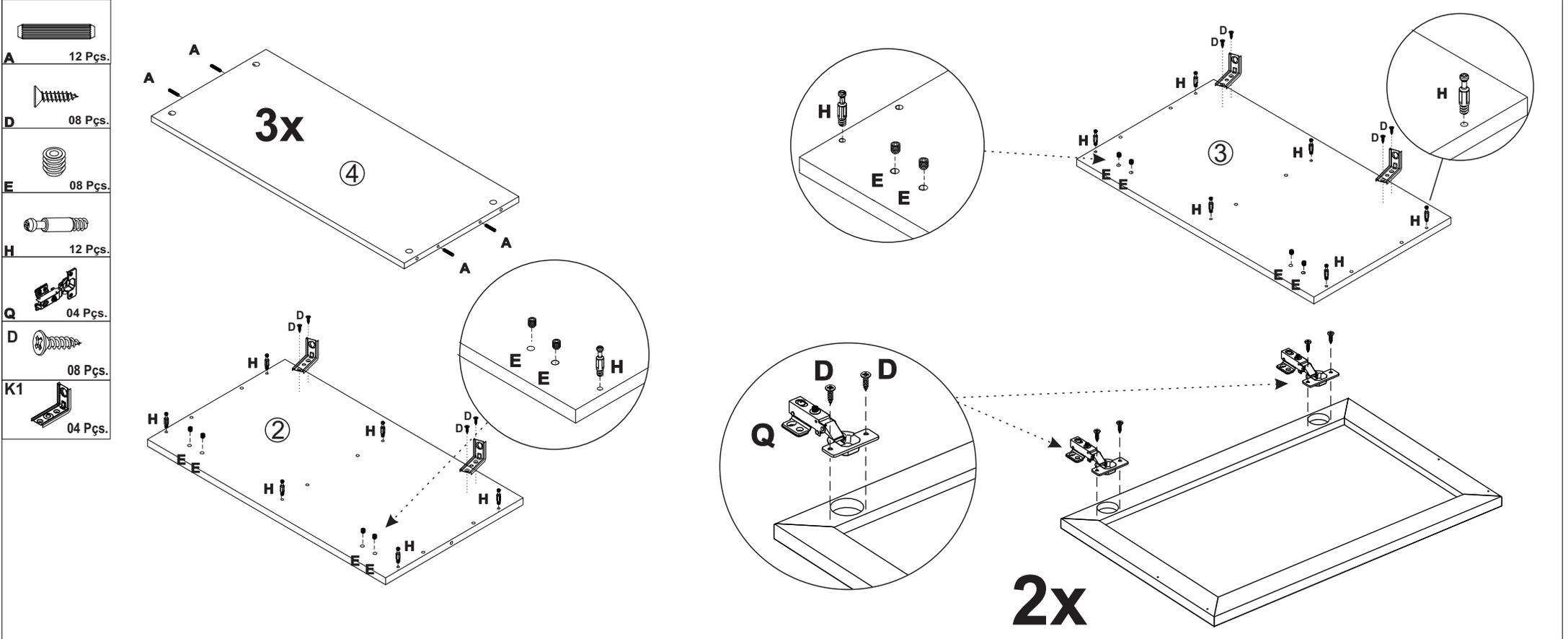
**PASSO - 02 MONTAGEM** Posicionar a lateral esquerda (3) e encaixar os tampos (4), fixando os girofix (G). Tampar o girofix utilizando a tampa plástica (O). conforme indicado.
