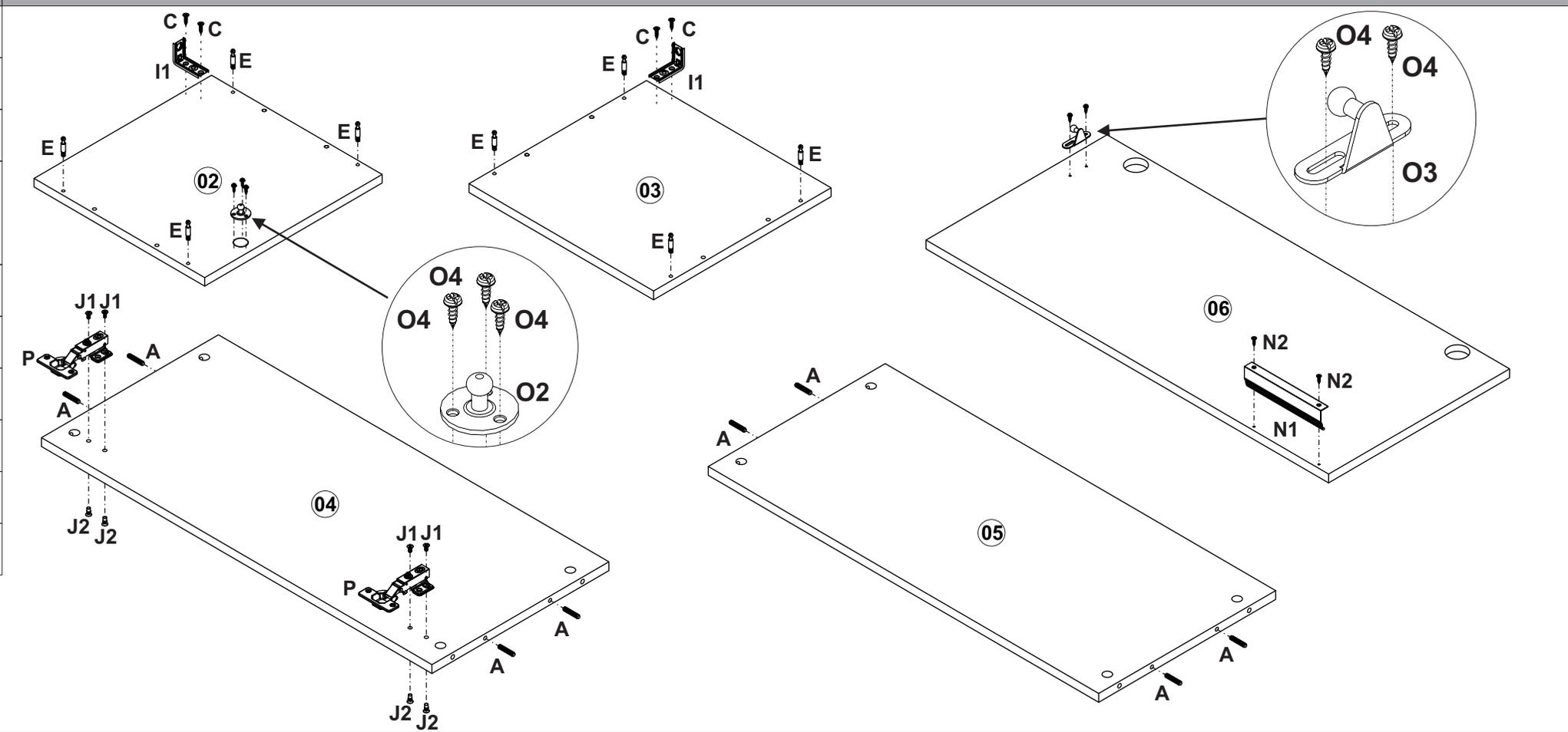
**Passo - 02 MONTAGEM** Montar o armário conforme a ilustração abaixo, unir as peças 02 e 03 nas peças 04 e 05, utilizando a ferragem D e M.
