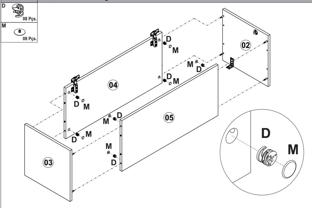
**Passo - 03 MONTAGEM** Montar o fundo conforme a ilustração abaixo, iniciar a montagem no armário de baixo para cima com peça 01, utilizando a ferragem B.
