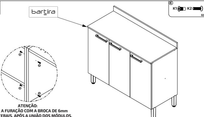
ATENÇÃO: FAZER A FURAÇÃO COM A BROCA DE 6mm NAS LATERAIS, APÓS A UNIÃO DOS MÓDULOS.
