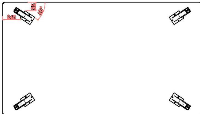
Obs: Posicionar os pés conforme as medidas para centralizar a furação.
