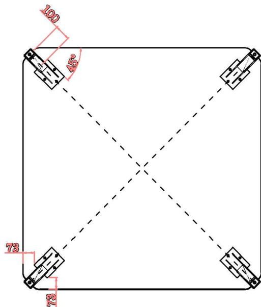
Obs: Posicionar os pés conforme as medidas para centralizar a furação.
