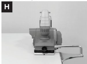
Figura H 5. Durante o corte, mantenha o guia sempre rente à lateral da peça. Isso evita cortes irregulares.
