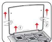
Remova a tampa segurando-a com as duas mãos. Desencaixe dos suportes (1) e puxe para cima (2). Lave a tampa de vidro com esponja, detergente neutro e água.
