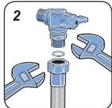
2. Encaixe o anel de vedação na outra extremidade e fixe o tubo flexível metálico no registro de parede com rosca externa 1/2", usando duas chaves ajustáveis.
