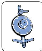
Use sempre um regulador de pressão para qualquer tipo de botijão. A ausência deste pode causar excesso de pressão e vazamento de gás. O regulador de pressão do gás deve ser de 2,75 (2,8) kPa de pressão e, no mínimo, 1kg/h de vazão, exclusivo para o fogão (condição para gás GLP).
