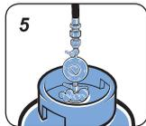
5. Ligue o gás e verifique se existem vazamentos utilizando o detergente líquido viscoso, que garante um melhor desempenho e eficácia do teste.
