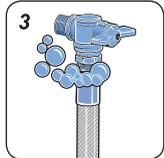
3. Ligar o gás e verificar se existem vazamentos utilizando o detergente líquido viscoso, que garante um melhor desempenho e eficácia do teste.
