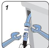
1. Encaixe o anel de vedação e uma das extremidades do tubo flexível metálico e fixe-o na entrada de gás do fogão usando duas chaves ajustáveis (chave inglesa).
