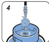
4. Conecte o regulador de gás ao botijão, apertando-o somente com as mãos. Este sistema foi desenvolvido para vedação somente com a força “manual”, não necessitando ferramentas.
