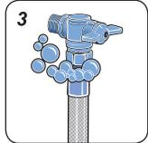
3. Ligue o gás e verifique se existem vazamentos utilizando o detergente líquido viscoso, que garante um melhor desempenho e eficácia do teste.
