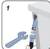
1. Encaixe o anel de vedação e uma das extremidades do tubo flexível metálico e fixe-o na entrada de gás do fogão usando uma chave ajustável (chave inglesa).
