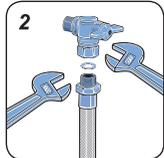
2. Encaixe o anel de vedação na outra extremidade e fixe o tubo flexível metálico no registro de parede com rosca interna 1/2", usando duas chaves ajustáveis.
