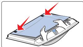
5. Para a montagem, encaixe o vidro interno nos suportes inferiores posicionando-o sobre a porta.
