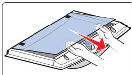
4. Retire o vidro interno e limpe os vidros e a porta com esponja, detergente neutro e água.
