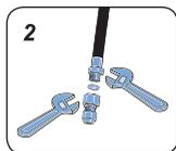
2. Encaixe o anel de vedação na outra extremidade e fixe o tubo flexível metálico no adaptador para “bico de mamadeira”, usando duas chaves ajustáveis.
