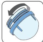
Para a retirada do protetor de vidro da lâmpada, gire-o no sentido anti-horário (para a esquerda). Para recolocar, proceda de maneira inversa.
