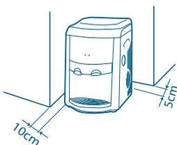
Para instalar o Purificador, mantenha as distâncias mínimas (conforme figura ao lado) da parede e outros móveis. Não tombe o produto.
