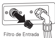
Filtro de Entrada
