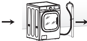
Ligação da mangueira de drenagem
