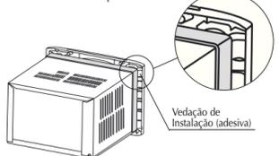
**1.4.2 Instalação na Parede**
