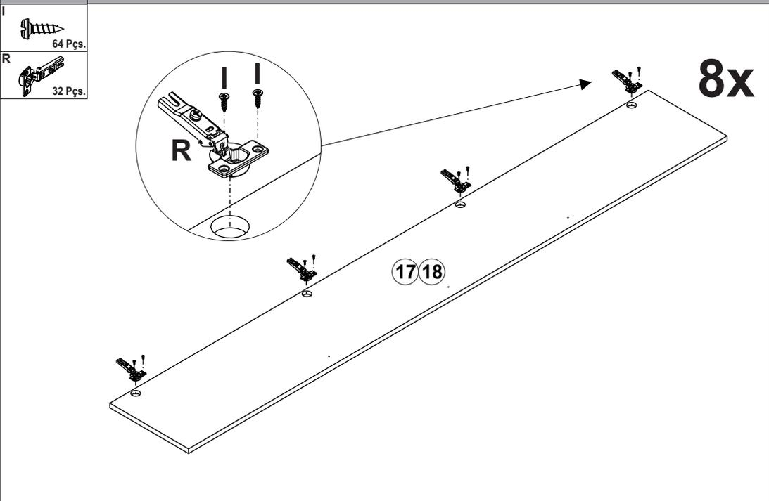
**Passo - 17 MONTAGEM** Montar as portas no armário conforme a ilustração abaixo, utilizar as ferragens e acessórios F, V e W nas peças 17 e 18.
