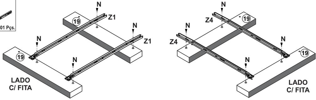
LOCAL DE FIXAÇÃO DOS PARAFUSOS NO TRILHO
