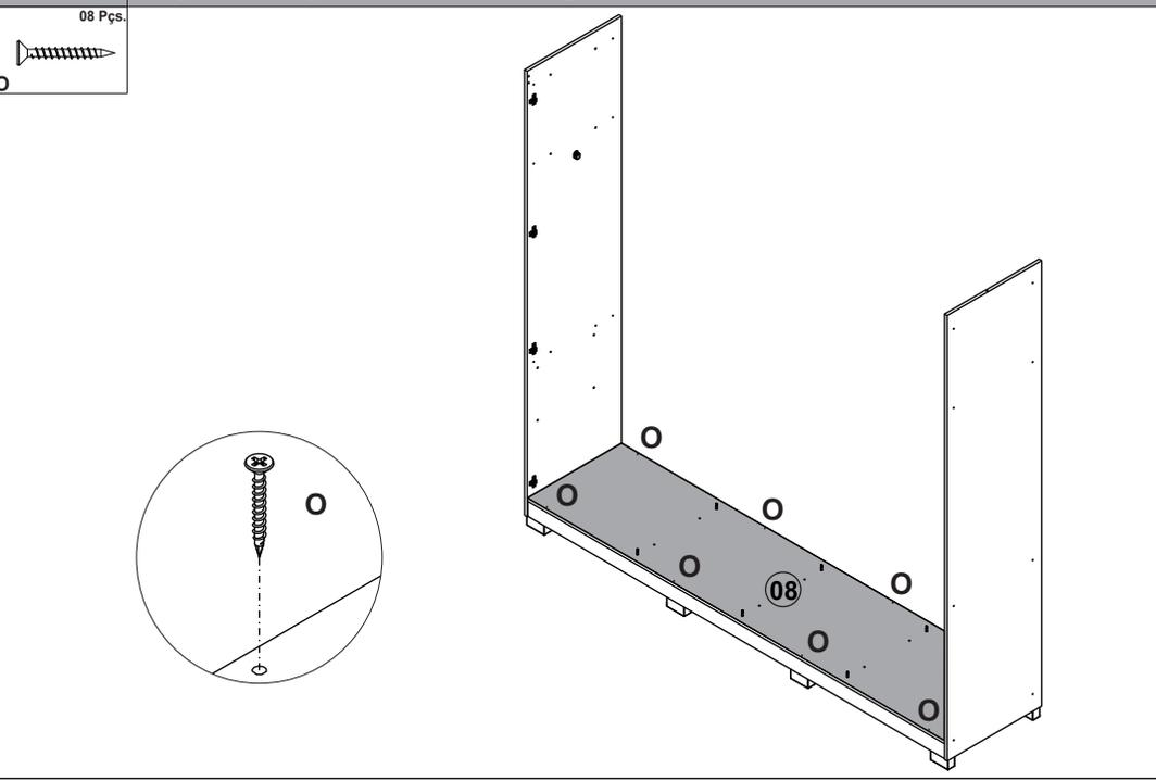
**Passo - 06 Montagem** Montar o divisor e as prateleiras no armário conforme a ilustração abaixo, unir a peça 11 na base, utilizando a ferragem K. Em seguida fixar as peças 09 entre o divisor e a lateral, utilizando a ferragem Q.
