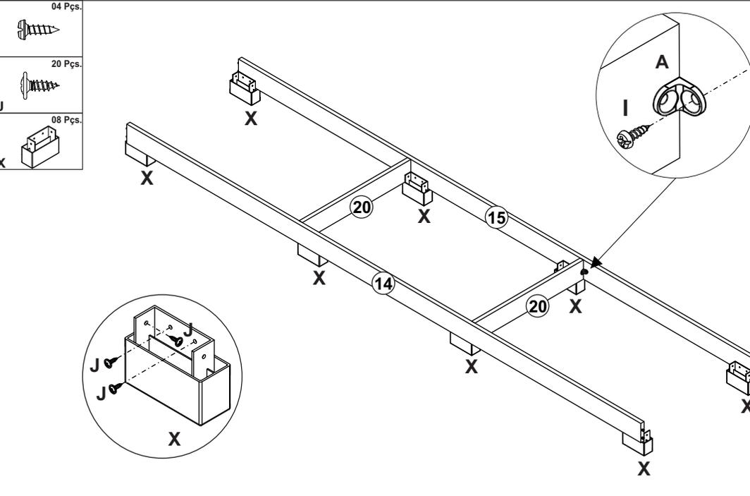
**Passo - 04 Montagem** Montar as laterais no rodapé conforme a ilustração abaixo, unir as peças 06 e 07, utilizando a ferragem Q. Em seguida fixar os pés com a ferragem J.
