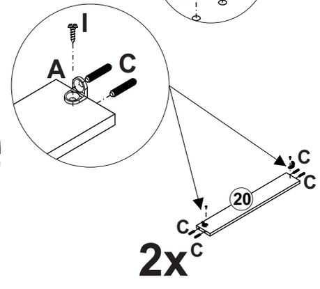
**Passo - 03 Montagem** Montar o conjunto rodapé conforme a ilustração abaixo, unir as peças 20 entre as peças 14 e 15, utilizando a ferragem I. Em seguida montar a ferragem X com a J.
