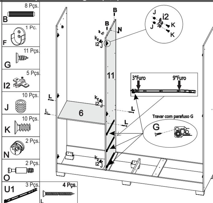
**Passo - 06** Prepare o divisor (10) e tampo (5) com as ferragens (B, F, G, i2, J, K, N, O, U4) encaixe e aperte a ferragem (N,L) conforme desenho abaixo.
