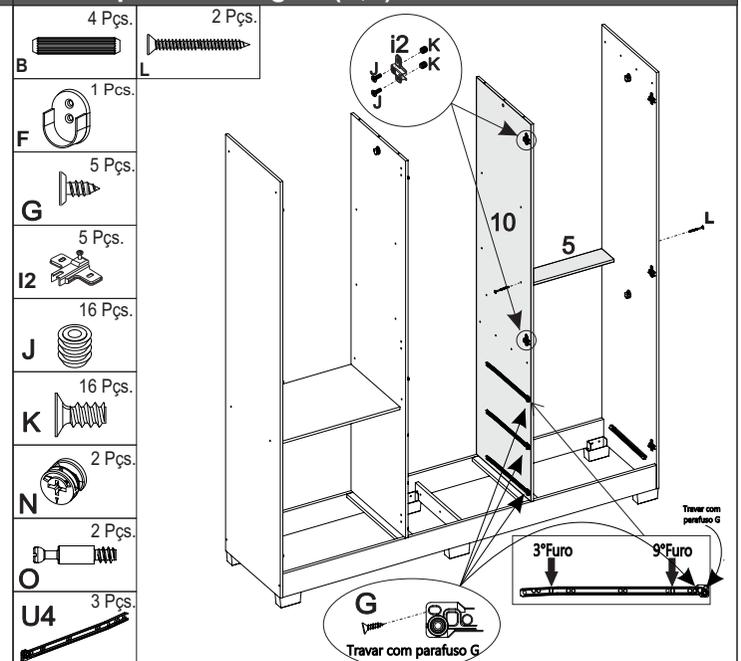
**Passo - 07** Prepare as peças 4, 6 com a ferragem (B) encaixe e fixe nos divisores e divisores e fixe o parafuso (L) conforme desenho abaixo.
