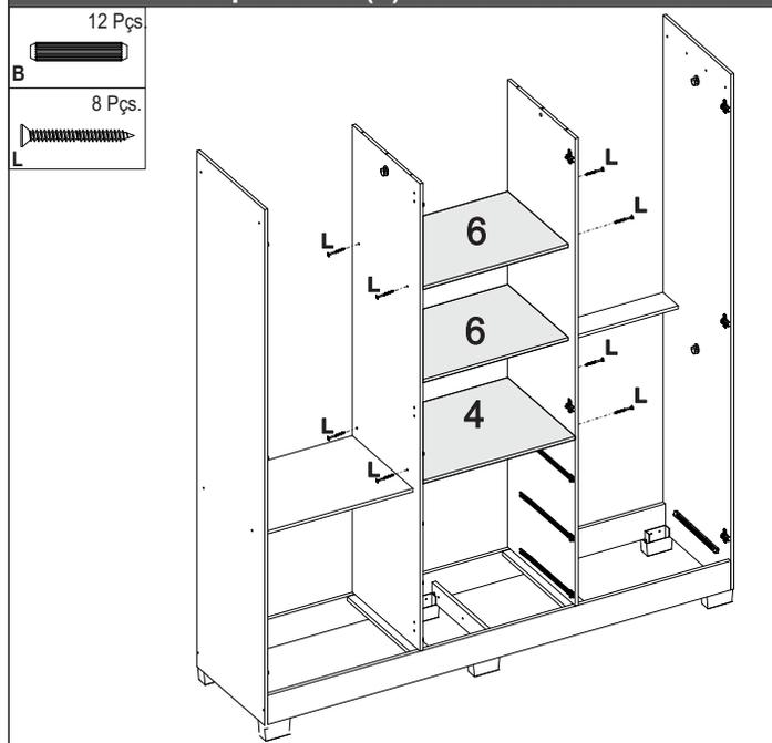
**Passo - 08** Prepare o tampo (6) com as ferragens (B, L, O) encaixe e aperte a ferragem (N,L) conforme desenho abaixo.
