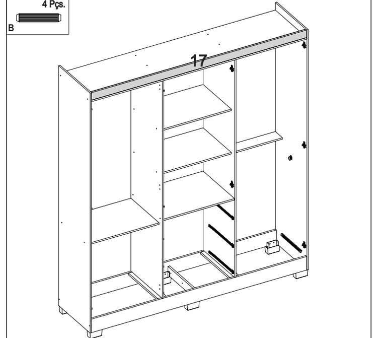
**Passo - 10 Armário** Fixe a moldura (17) com a ferragens (H) nas marcações indicadas na face do tampo
