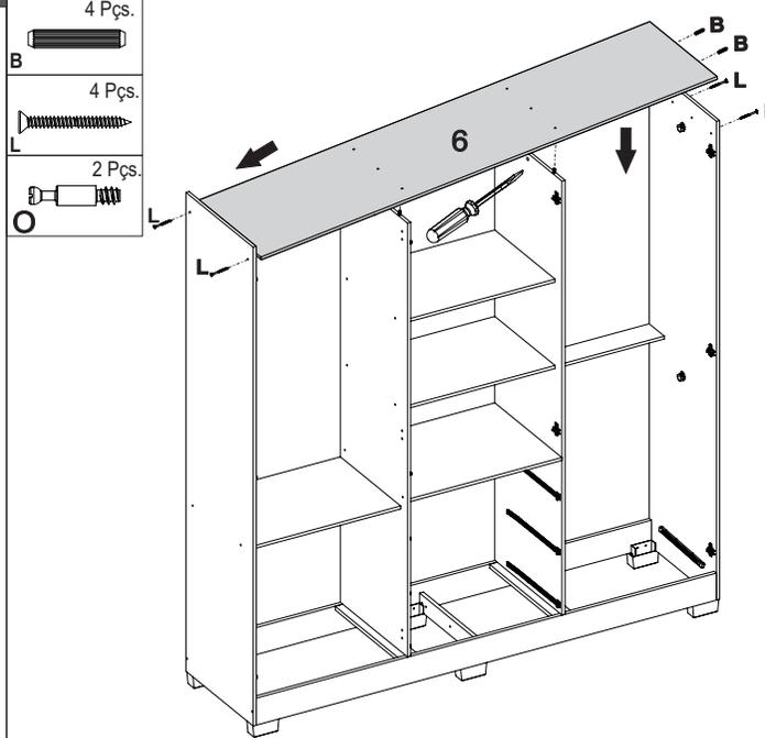
**Passo - 09** Prepare a moldura (17) com a ferragens (B) encaixe nas laterais conforme desenho abaixo.
