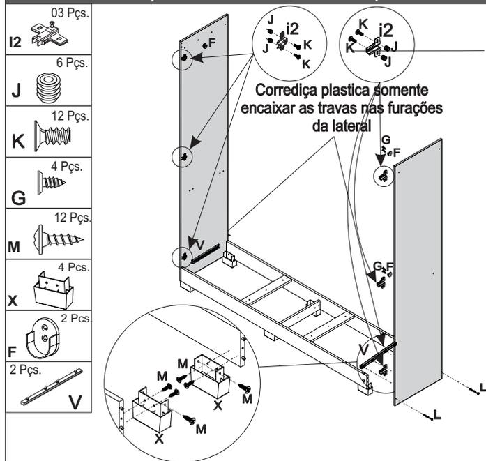
**Passo - 05** Prepare o divisor (11) e prateleira (6) com as ferragens (B, F, G, i2, J, K, N, O, U1) encaixe e aperte a ferragem (N,L) conforme desenho abaixo
