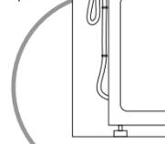
Nunca solte a mangueira de saída de água da abraçadeira fixada no gabinete, pois além de evitar cortes na mangueira, a abraçadeira garante a altura necessária para o funcionamento correto da Lavadora. Caso o comprimento da mangueira não seja suficiente para atingir o ponto de escoamento, procure a **Rede de Serviços Consul** - para a compra de uma mangueira disponível com 2,30 m de comprimento.
