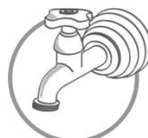
4. Recomenda-se que haja uma torneira exclusiva para a entrada de água da lavadora. É obrigatória a utilização de uma torneira com rosca 3/4 de polegada para a instalação da mangueira de entrada de água, a não utilização dela pode gerar vazamentos.
